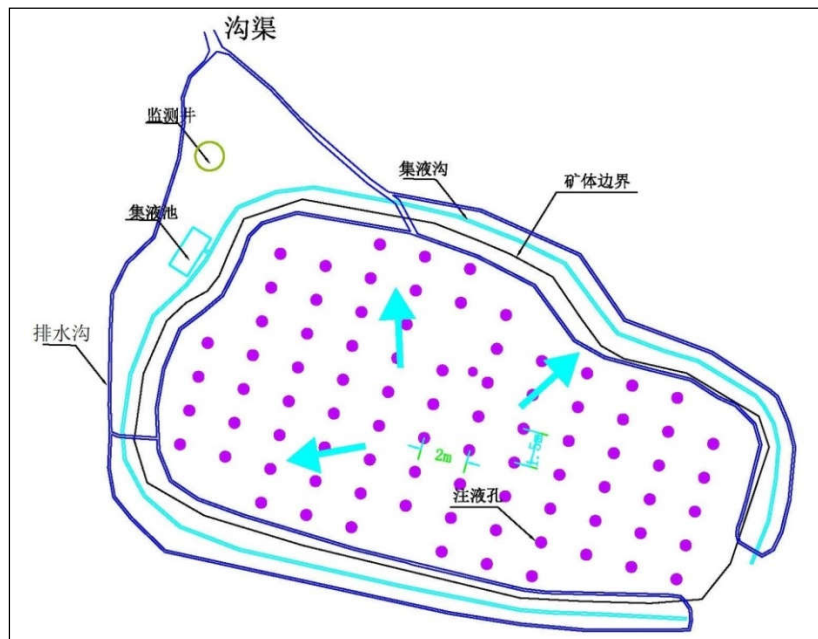
图 6.4-1 各矿块的清污分流示意图
